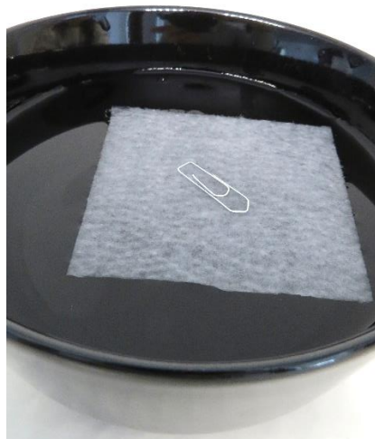
Bild 6: Büroklammer auf ein schwimmendes Papiertuch legen (Forscherstation)
